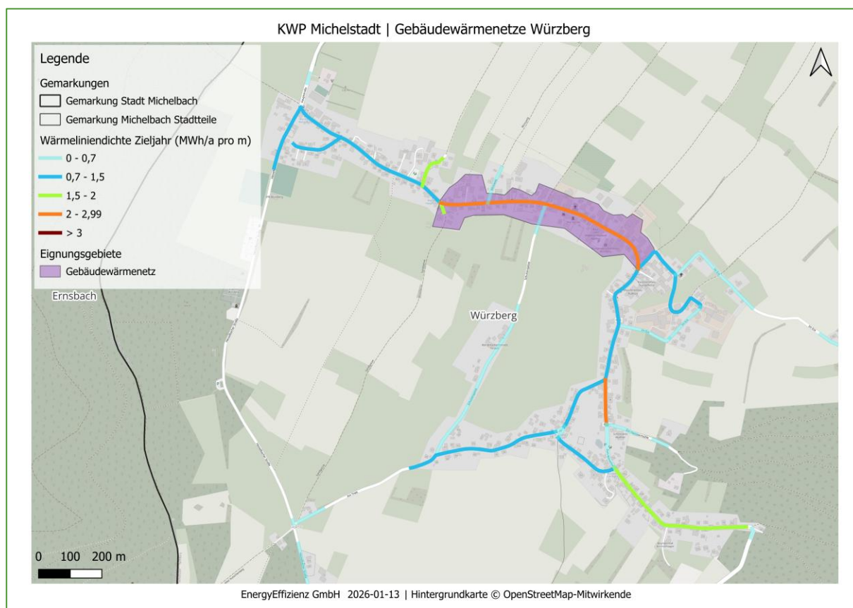
Abbildung 52: Fokusgebiet 3 – Gebäudewärmenetzgebiet in Würzburg
